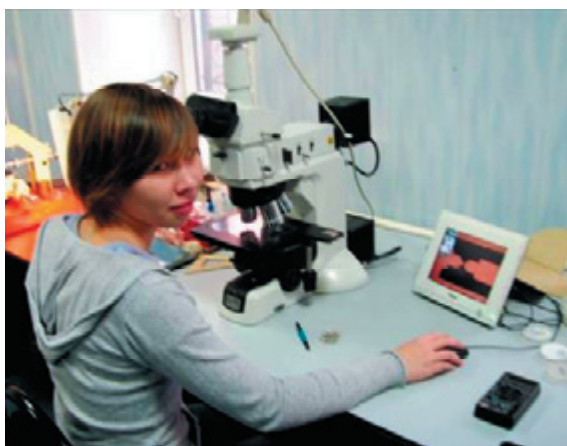
Исследование датчика с помощью оптического микроскопа не позволяет выявить дефекты
