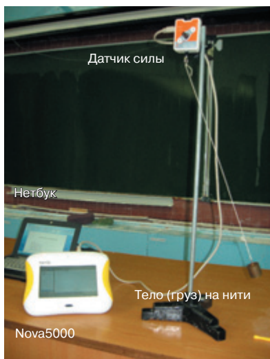
Экспериментальная установка для исследования перегрузок, возникающих при разных видах движения (внизу) и графики зависимости веса тела от времени: а) при колебаниях груза на нити; б) при колебаниях пружинного маятника; в, г) в поднимающемся лифте; д, е) в опускающемся лифте; ж) при автомобильной аварии. Справа: эксперимент проводит Владислав Нарчук
