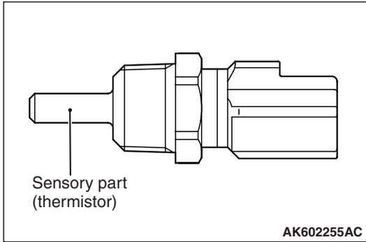
**ENGINE COOLANT TEMPERATURE SENSOR**
