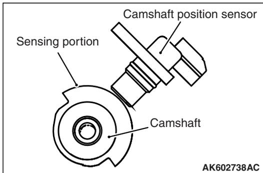
**INTAKE CAMSHAFT POSITION SENSOR**
