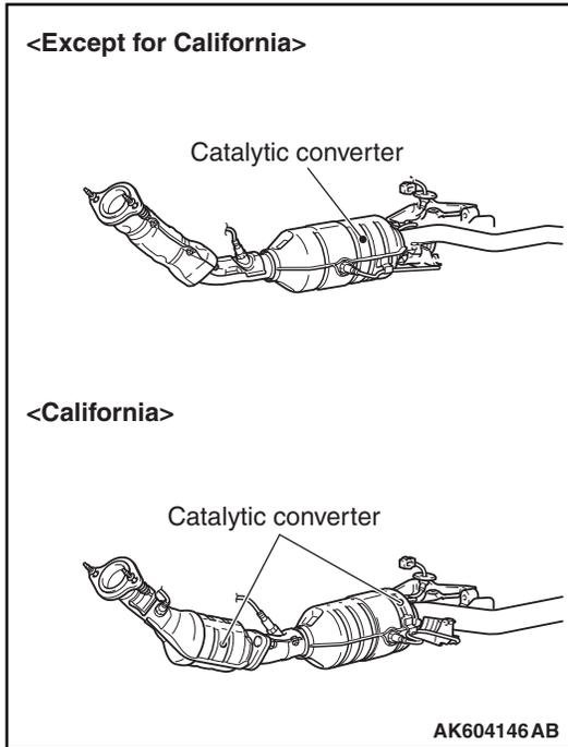
**3. HC TRAP CATALYTIC CONVERTER**
